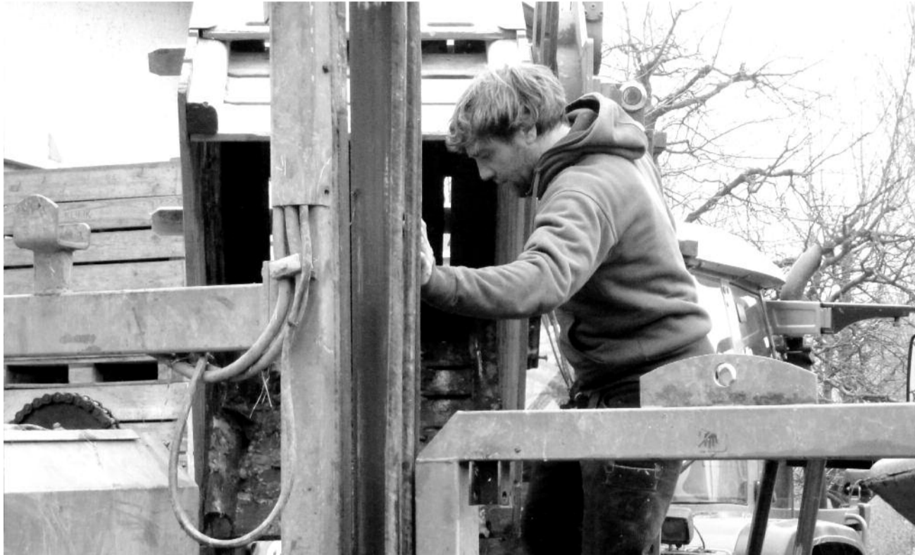
Ein erster Versuch: Jonas Schenk beobachtet das Verhalten der Ölkürbisse in der vom Traktor angetriebenen Dreschmaschine. Möglichst alle Samen sollen vom Fruchtfleisch gelöst und aufgefangen werden.
