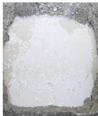
*Sondierschacht mit Wasserspiegel von 2,6 m unter Terrain*
